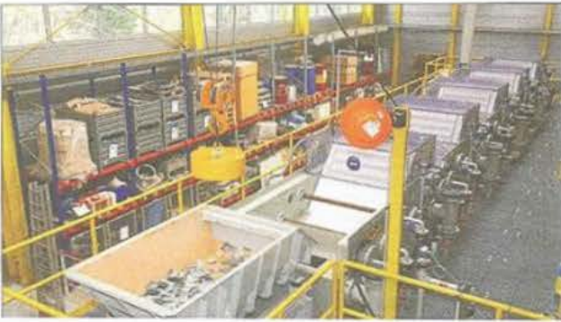
Einsatzbereit und nah an der industriellen Umsetzung: die neue Versuchsanlage zur Entzinkung von Stahlschrotten.
