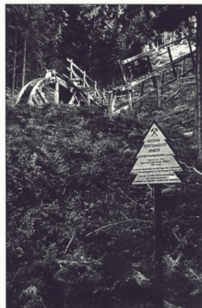
6 Das wieder errichtete Feldgestänge mit Kunstrad am Maaßener Geipel Foto: Ruder
